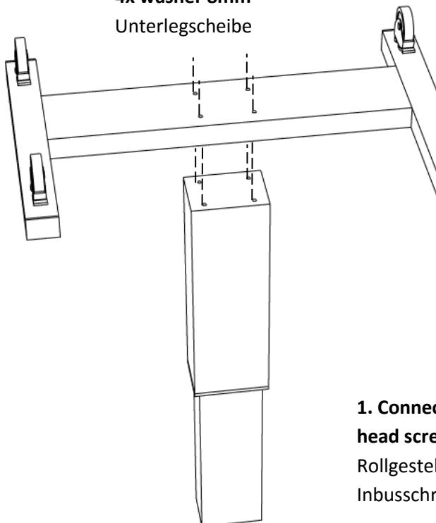
**1. Connect the trolley to the column. Use 4x Allen head screw M8x40 and washer.** Verbinden Sie Rollgestell und Pylone. Verwenden Sie 4x Inbusschraube M8x40 und Unterlegscheibe.
