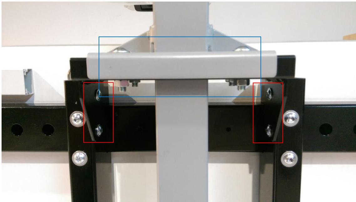
**4x Allen head lens screw with flange M8x35** Linsenkopfinbusschraube mit Flansch
